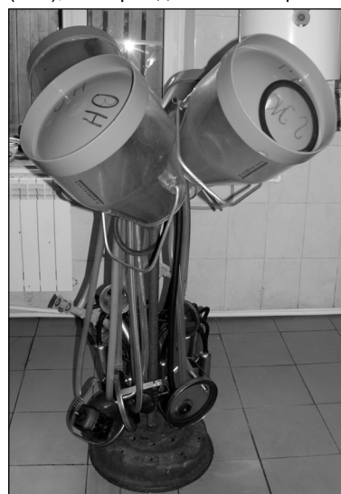
● Приспособление для хранения и сушки бидонов, изготовленное руками местных умельцев.
